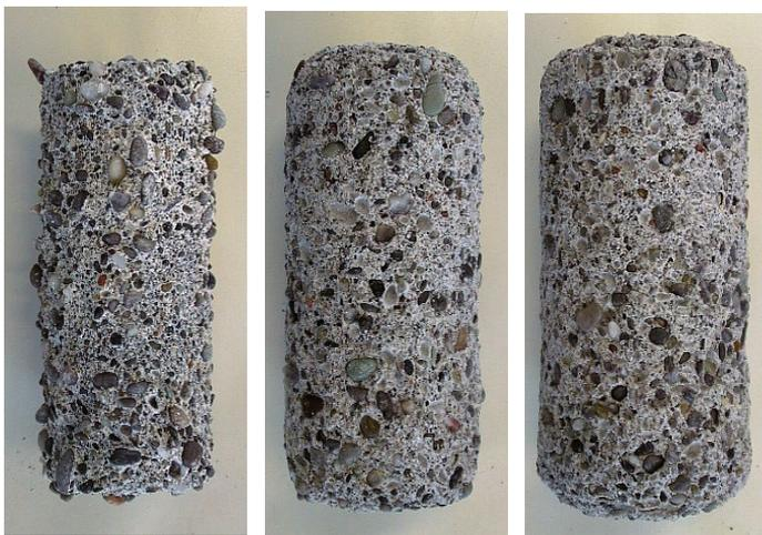
普通ポルトランド 100%      スピリッツ 4000 50%置換      スピリッツ 4000 70%置換
